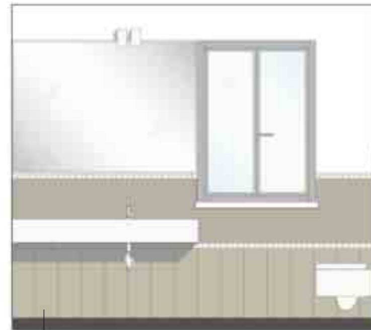
Fascia inferiore + mosaico + mosaico 20x60 cm Greige 5x5 cm Aspen Bianco 1,8x1,8 cm Spring Greige inciso
