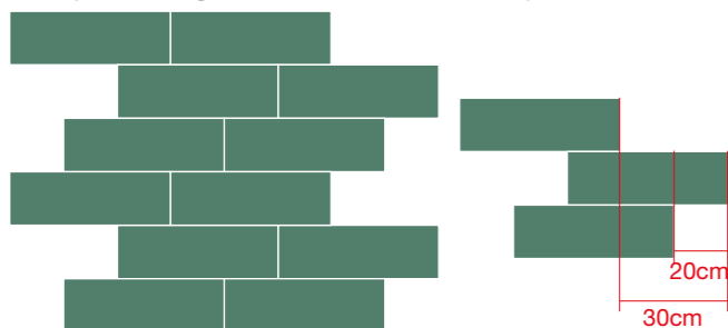
4 - Укладка вразбежку с фиксированным смещением по три прямых ряда 4 - Posa a modulo regolare a tre file 4 - Triple file regular module installation pattern
